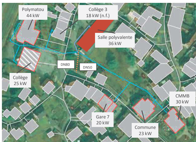
Figure 2 : Diamètre des conduites
