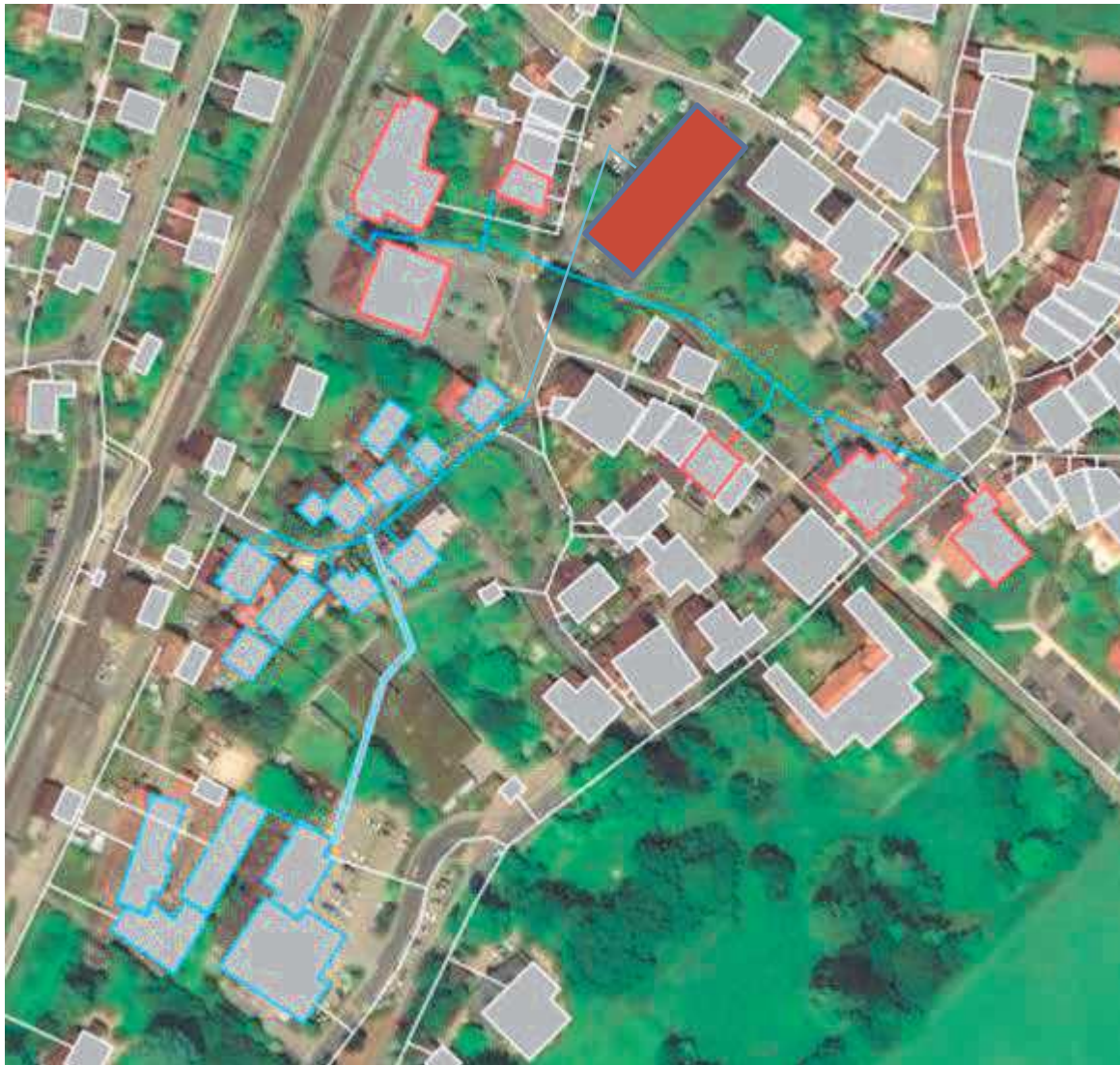
Figure 5 : Tracé du CAD selon scénario 3. Bâtiments entourés de rouge : actuellement raccordés ; bâtiments entourés de bleu : extension envisagée
