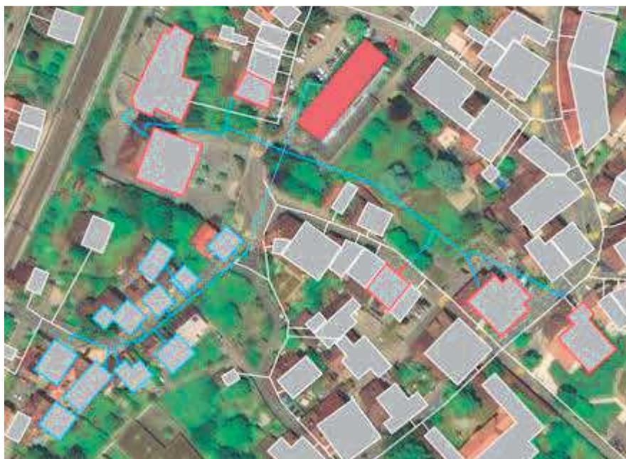
Figure 4 : Tracé du réseau pour le scénario 2. Bâtiments entourés de rouge : actuellement raccordés ; bâtiments entourés de bleu : extension envisagée
