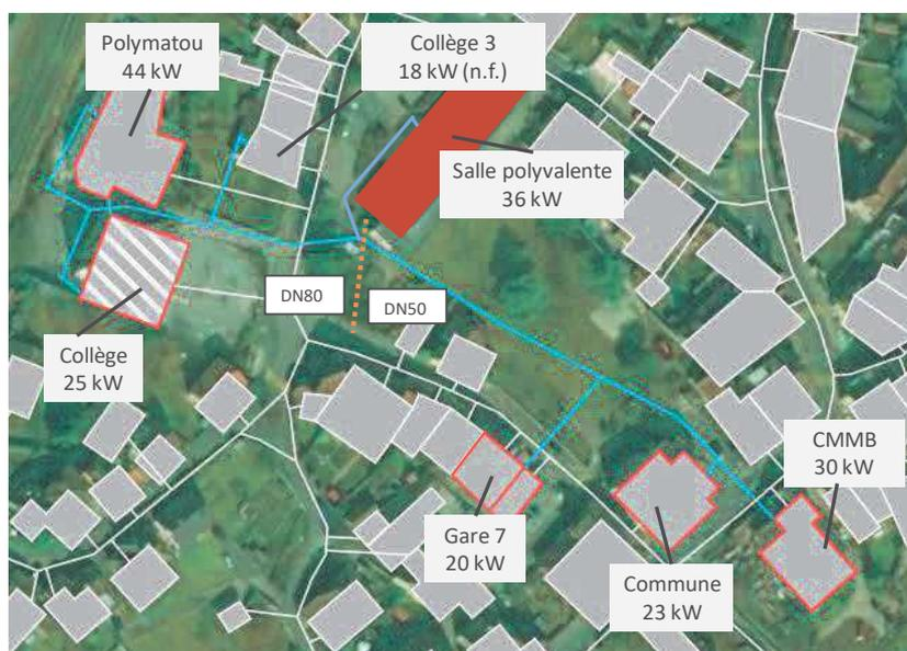
Figure 2 : Diamètre des conduites
