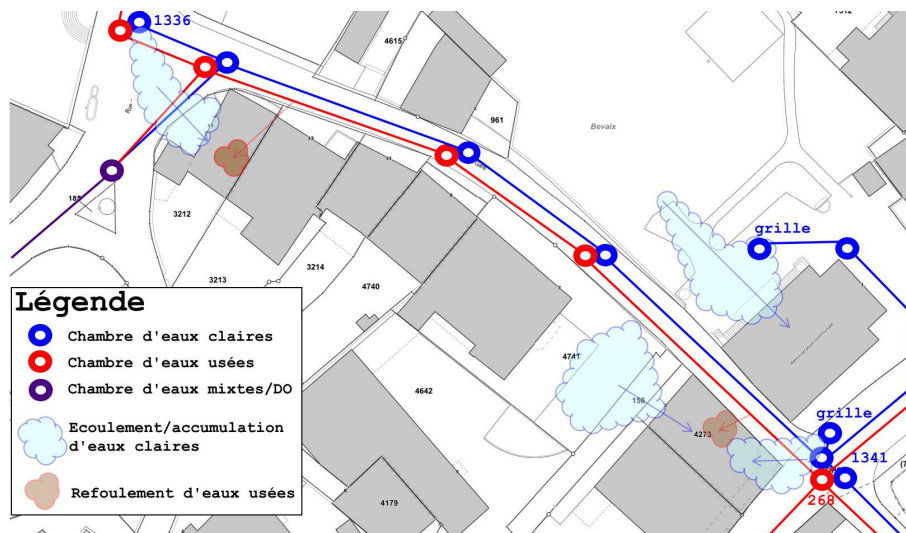
Figure 1 Représentation schématique des phénomènes décrits par les témoins des inondations
