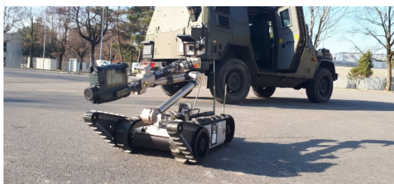
Figure 4 Robot d'exploration équipé d'un appareil de radiométrie portable
