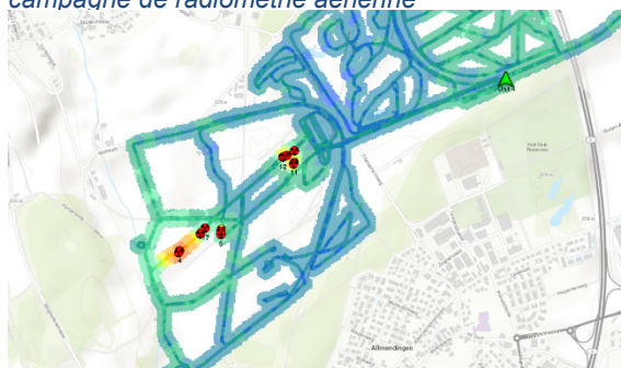
Figure 6 Exercice de recherche de sources radioactives avec un véhicule de radiométrie
